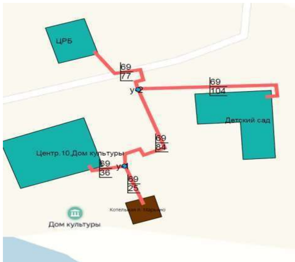
Рисунок 2. Схема тепловой сети от источника тепловой энергии Котельная № 35 с. Марьино
