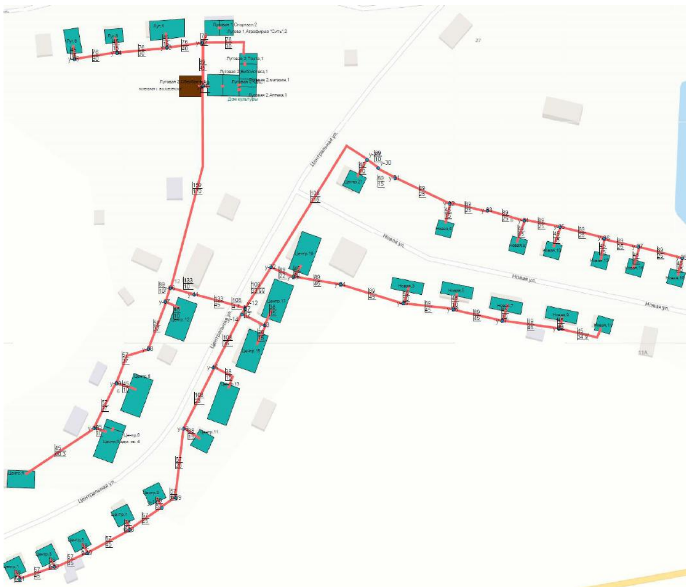
Схема сетей отопления от котельной с. Воскресенское, ул. Центральная
